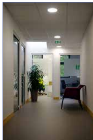
Les bureaux, 3 doubles et 7 individuels, bénéficient d'un éclairage naturel en périphérie, l'éclairage artificiel se fait par led avec détecteur de présence. Le couloir et la salle de réunion bénéficient d'un éclairage zénithal grâce aux puits de jour. Une douzaine de personnes travaillent dans ces nouveaux locaux. (Photo Eric Solé)
